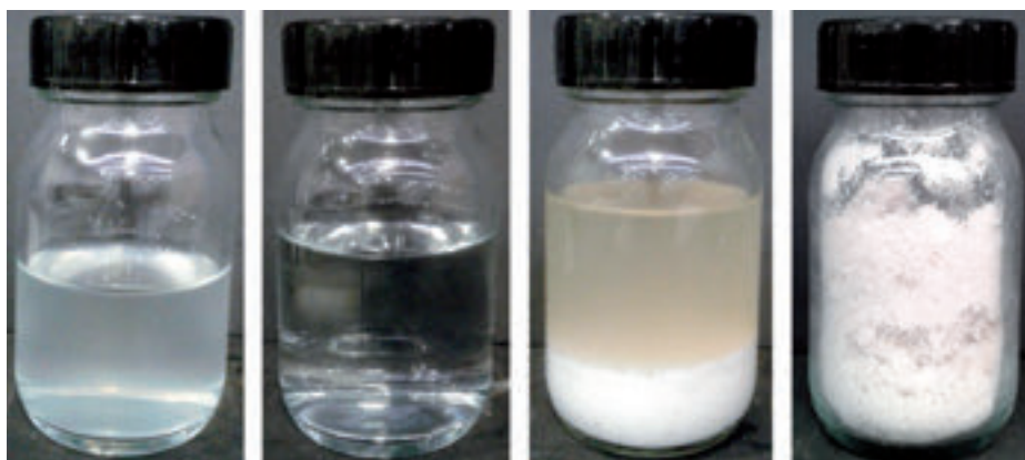
Foto dei campioni rappresentativi del processo (da sinistra a destra): soluzione talquale destinata al trattamento; distillato e concentrato ottenuto dal processo di evaporazione; cloruro di ammonio in cristalli estratto dalla centrifuga.
